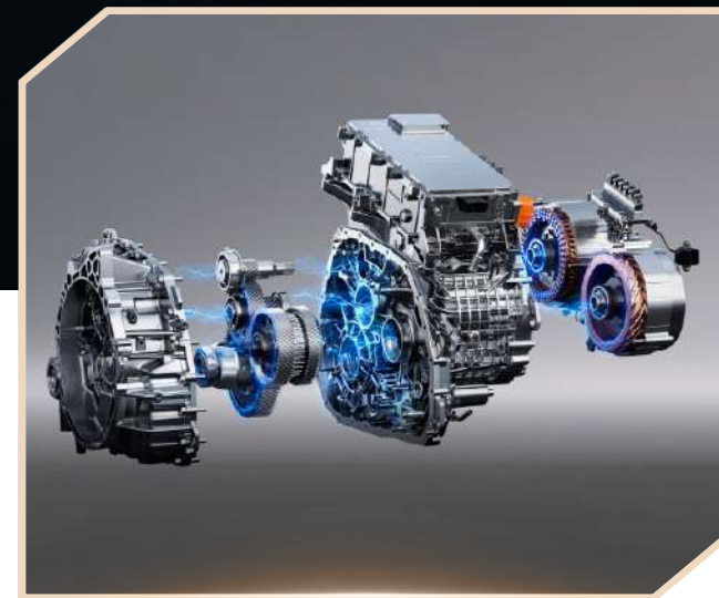
MOTOR SÍNCRONO DE IMANES PERMANENTES, 201 HP DE POTENCIA Y 310 NM DE TORQUE
