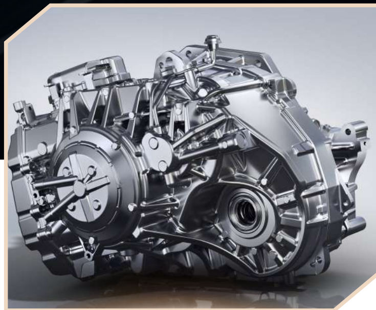
TRANSMISIÓN AUTOMÁTICA 8 velocidades (2.0 AWD) 7 velocidades (1.5 4x2)
